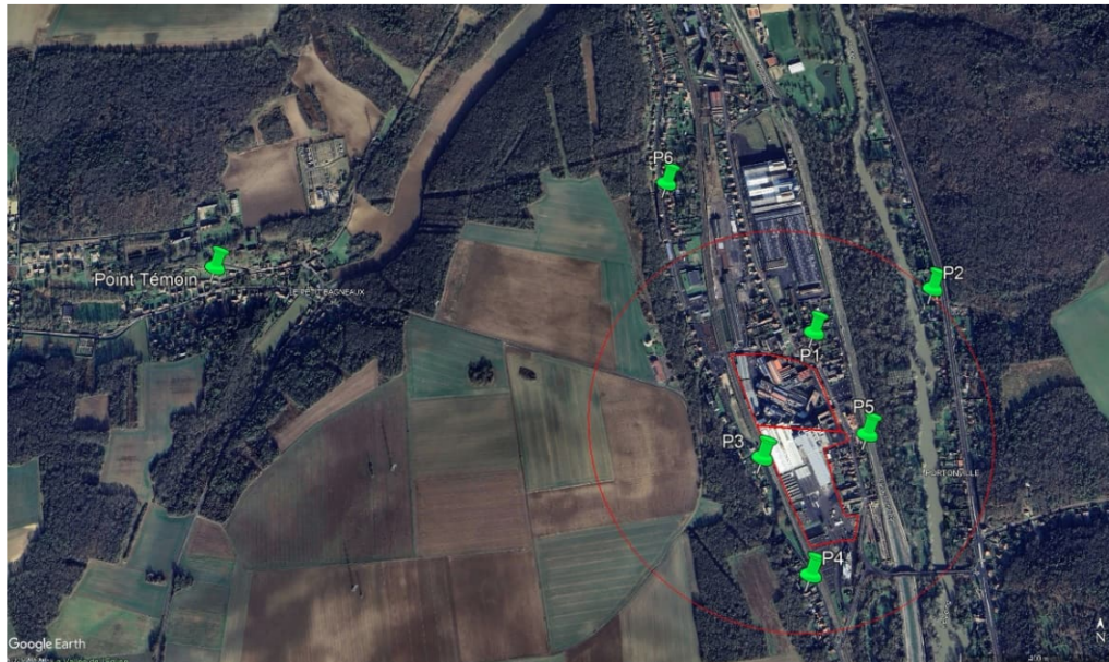
Figure 7 : Plan de surveillance des dépôts atmosphériques répondant aux recommandations du guide de surveillance dans l'air autour des installations classées
