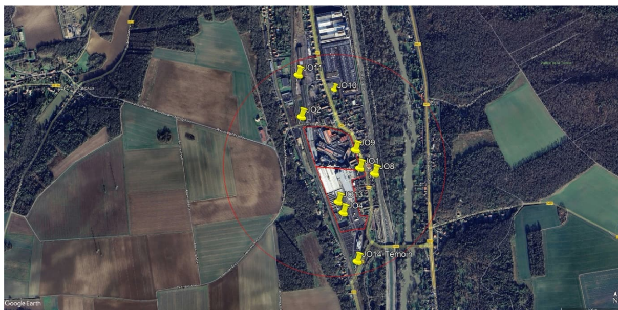
Figure 1 : Implantation des collecteurs pour les dépôts atmosphériques depuis 2018 (Polygone rouge : sites industriels, cercle rouge de 500 m autour des installations)
