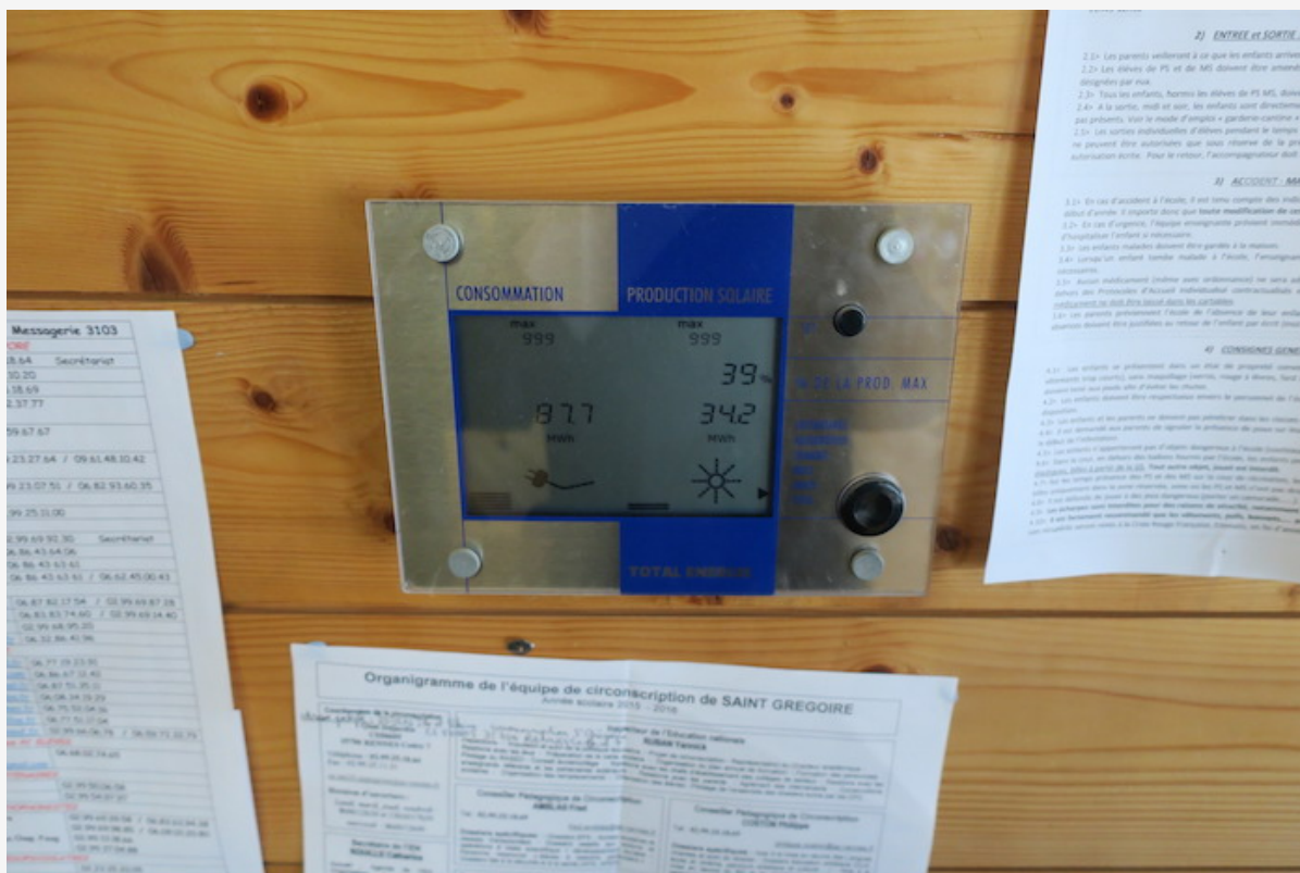
Le compteur pédagogique mesurant la production des panneaux solaires sur le toit de l'école.
