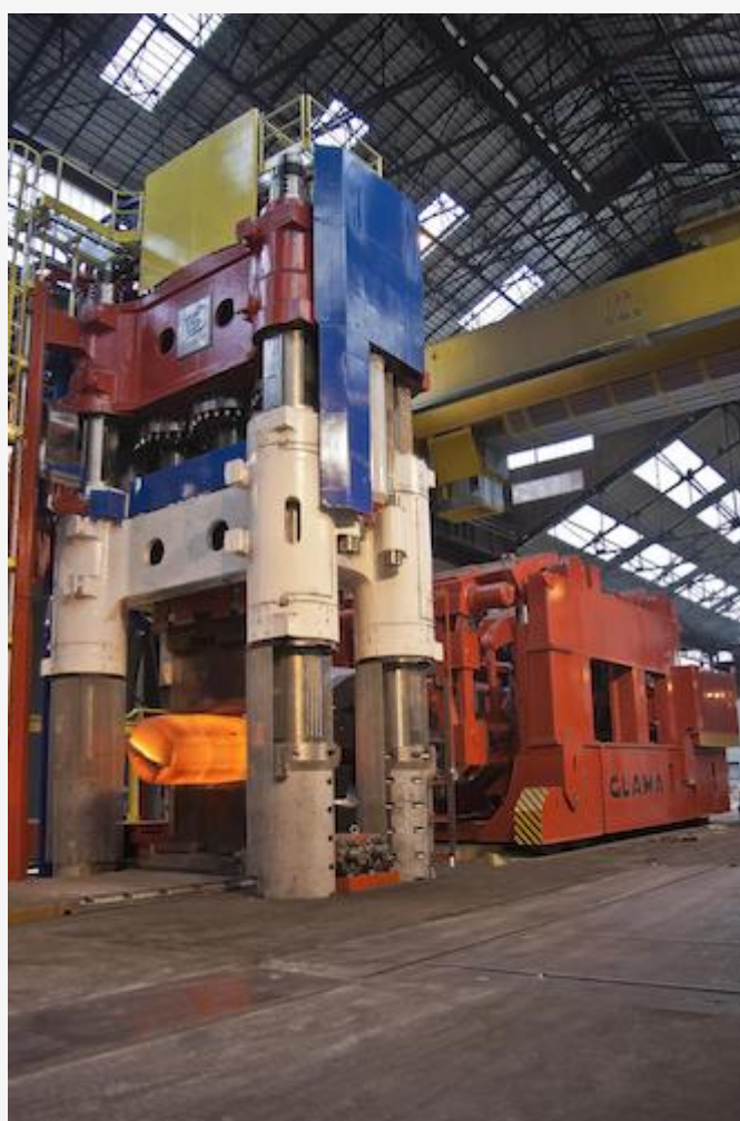
Un «ensemble manipulateur-presse» de 9.000 tonnes sur le site du Creusot Forge, en 2014.
